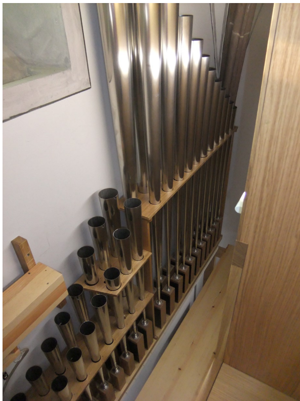
Abb.9: Die Pfeifen der Zungenregister des Pedals stehen an der Emporenrückwand hinter dem Schwellwerk. Auf dieser Windlade erklingen Posaune 16' und Basstrompete 8'.
