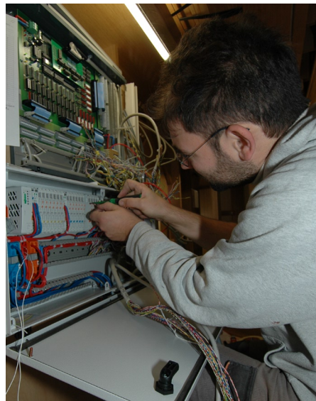
Abb.7: Orgelbauer Christian Kleibusch verdrahtet das FABUS-System zur Steuerung von Pedaltraktur und Koppeln.
