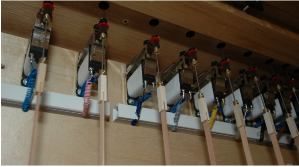
Abb.6: Blick auf die Tonventilmagnete der Schwellwerkswindlade. Sie kommen bei den Normal-Sub- und Superkoppeln zum Einsatz
