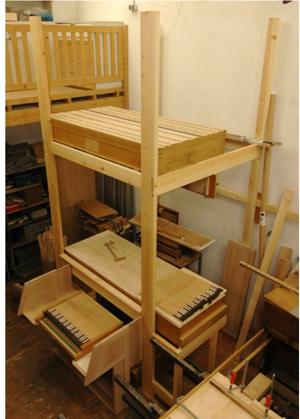
Bild 7: In der Werkstatt ist der Grundaufbau gut erkennbar. Im „Erdgeschoss“ befinden sich der Spieltisch und die Unterwerkslade (auf der die Tasten des Hauptwerks liegen), darüber die Hauptwerkswindlade. Die Pedalwindlade fehlt hier noch.
