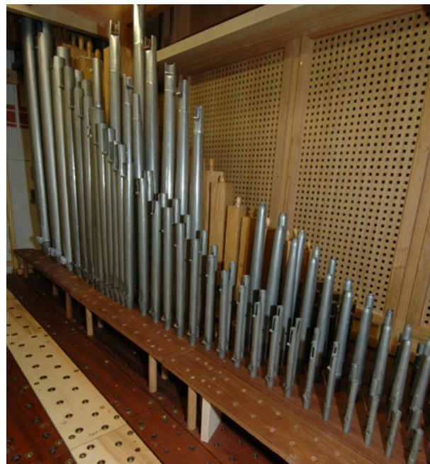
Bild 13: Die Pfeifen im Unterwerk werden eingebaut. Im Vordergrund der erneuerte Stock des Nachthorn 4'.
