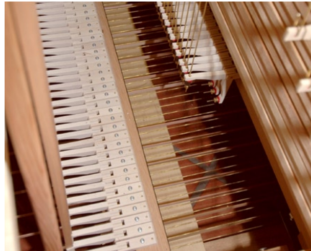
Bild 5: Blick auf die Winkelbalken zur Umlenkung der Tontraktur im Untergehäuse.
