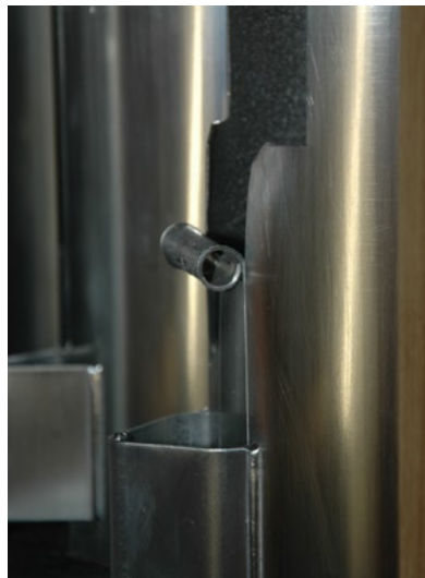
Bild 16: Blick auf die Stimmrolle einer Prospektpipe im Seitenfeld. Hiermit kann die Tonhöhe der Pfeife verändert werden.
