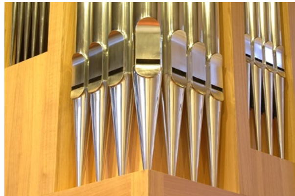
Bild 11: Im Eckturm stehen die tiefsten Pfeifen des Principal 8'.
