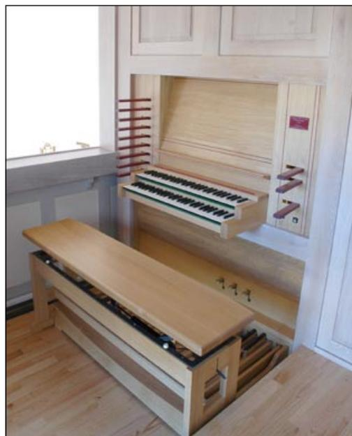
*Bild 7: Die Spielanlage. Links die Registerschwerter der Manuale, rechts sind Pedal und Tremulant angeordnet.*
