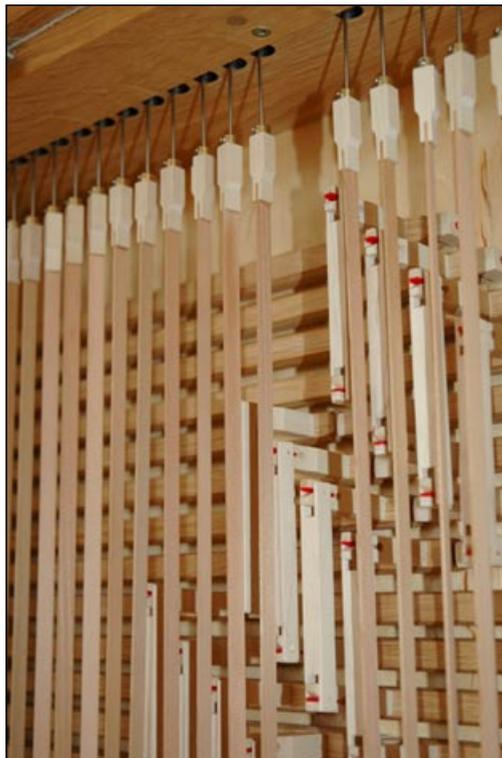
*Bild 3: Blick auf die Spieltraktur der Manualwindlade. Die Abstrakten gehören immer abwechselnd zum I. und II. Manual.*
