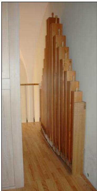
*Bild 6: Der Subbass an der Emporenrückwand.*
